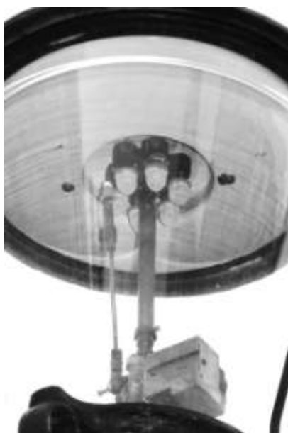
Binnenwerk van de Rittergaslamp. Duidelijk zijn de zes kousjes en de waakvlam te zien
